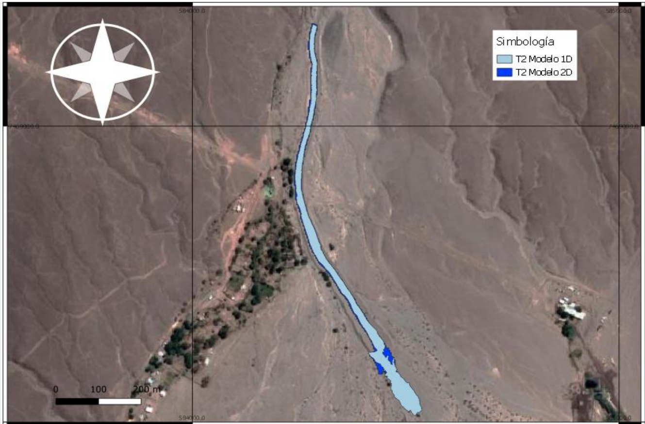
FIGURA 4-171: SUPERFICIE DE INUNDACIÓN RIO VILAMA PARA T2
