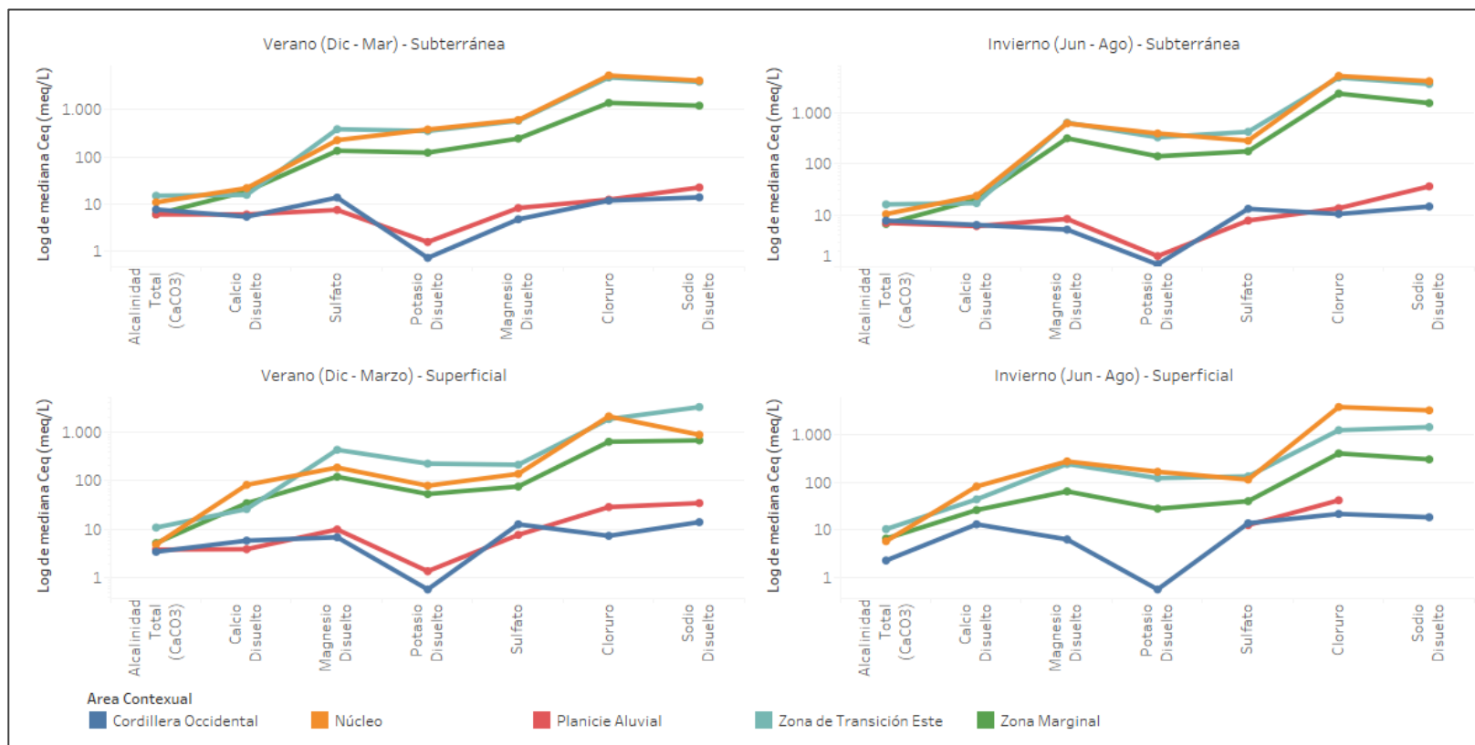
Figura 4-212. Diagramas Schröeller Berkaloff para las distintas unidades geomorfológicas en verano (diciembre a marzo) e invierno (junio a agosto) Ceq: Concentración equivalente en (meq/L)
