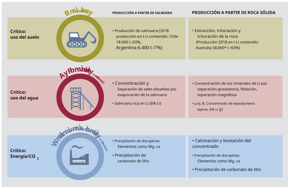
Figura 1: Extracción, procesamiento y procesamiento posterior (hasta carbonato de litio) presentados para el litio de salmuera y roca sólida, así como puntos críticos desde una perspectiva de sostenibilidad.
