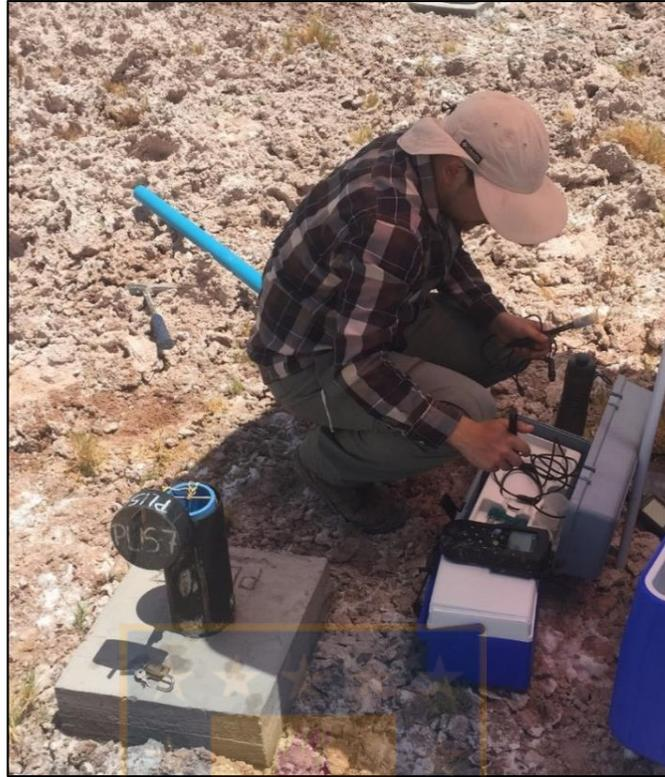
**Figura 3.2:** Medición de parámetros fisicoquímicos de agua subterránea. Muestra L1C4W1.
