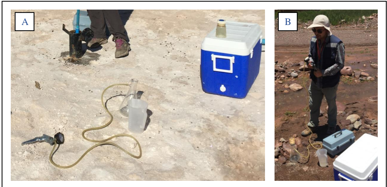
Figura 3.3: Sistema de filtrado. a) Partes del sistema de filtrado. Vaso con porta filtro sobre el cooler. b) Filtrado in situ de una muestra.
