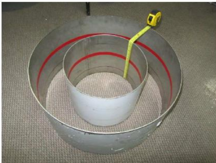
Figura 15-2: propuesta de instalación de los anillos de infiltración
