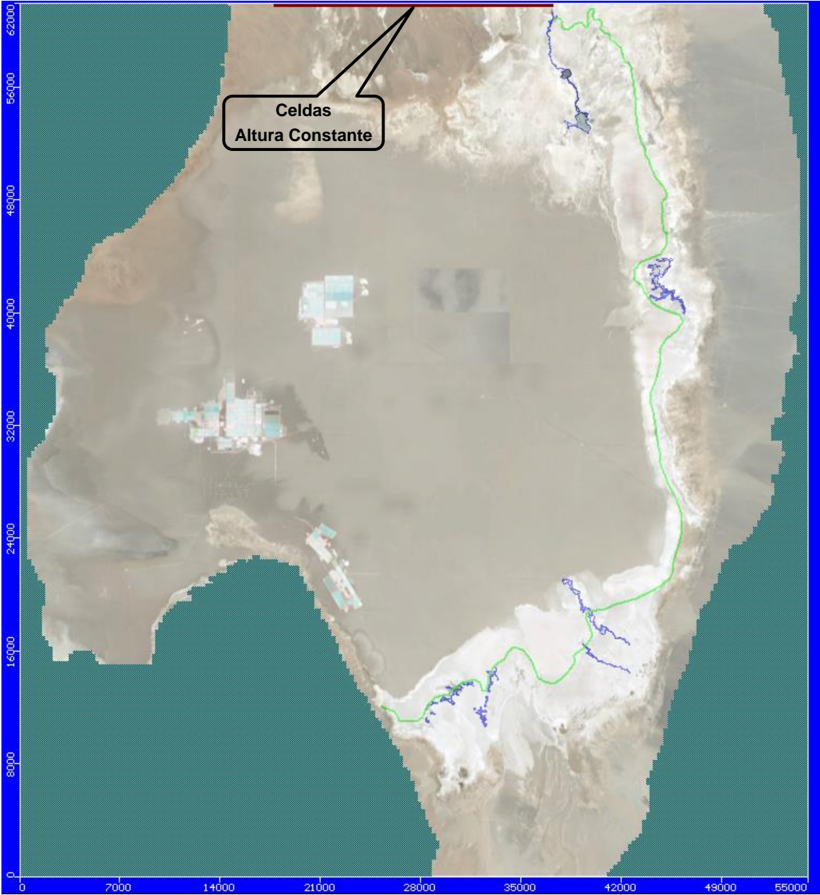
Figura 10-9 Celdas de Altura Constante en Recarga desde el Norte
