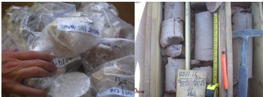
Foto 1: Extracción de muestras. A la izquierda se observan muestras de sondajes recolectadas. A la derecha, una típica vista del estado del sondaje DDH-16
