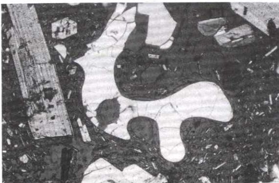
Foto 7. Microfotografía de una dacita de biotita y oxihornblenda, con grandes fenocristales de cuarzo con embahamiento y pequeños clinopiroxenos (To-167); Estrato-volcanes II, Acamarachi Oeste (Nícoles cruzados. x18).
